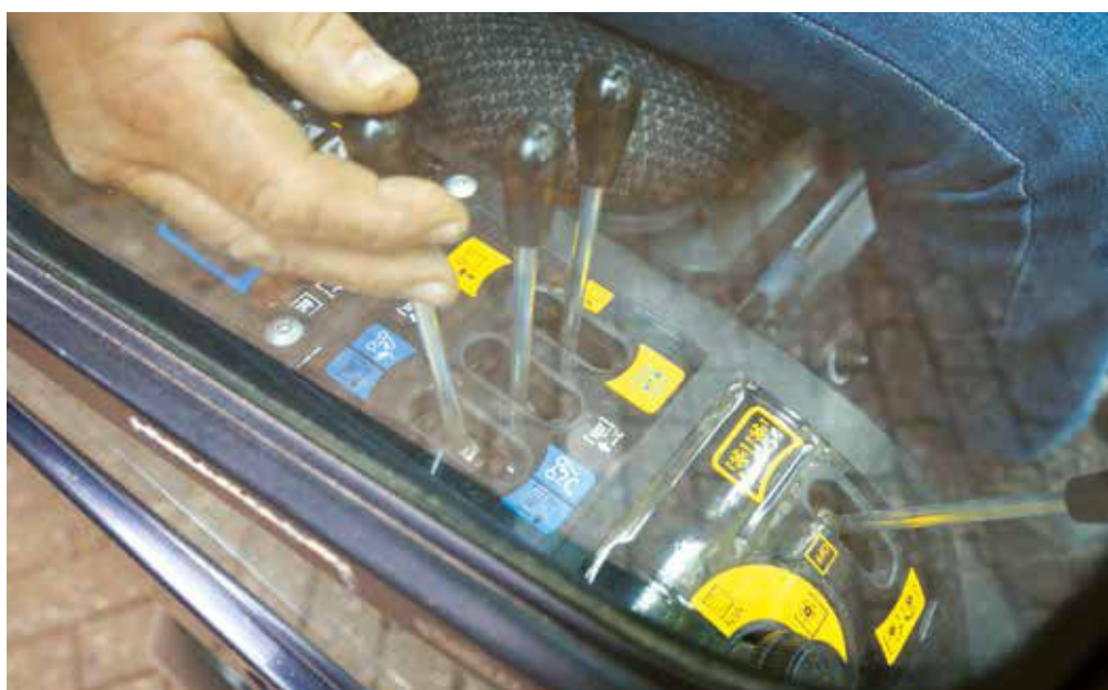
Die Entleerung des Sammelbehälters erfolgt aus der Fahrerkabine – ohne weitere Kraftanstrengung für den Bediener.
